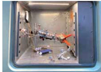
Рис. 2. Конструктивна схема експериментальної установки (а) та камера з розташованою всередині робочою ділянкою з ГРТТ (б):
