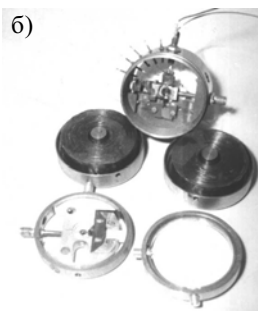
Рис. 4. Лабораторная модель измерителя магнитных полей: a — общий вид измерителя; b — элементы конструкции измерителя
