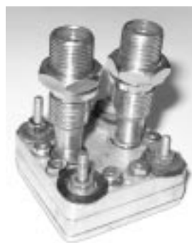
Рис. 4. Внешний вид двухканального щелевого теплообменника с переходными резьбовыми втулками
