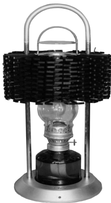
Рис. 3. Термогенератор с керосиновой лампой Алтек-8019
