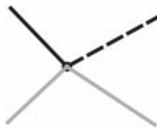
Рис. 10. Добавление в «сером» слое сегмента, соединяющего межслойные переходы, позволяет убрать один из переходов
