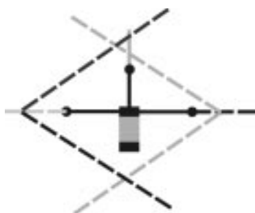
Рис. 8. «Оттяжка» проводников за межслойные переходы
