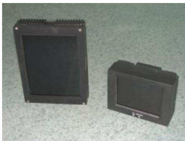
Рис. 4. ЖК-мониторы в портретном (10,4") и альбомном (6,5") вариантах исполнения
