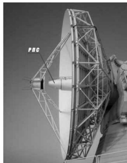
Рис. 1. Фотография антенны радиотелескопа с РПС
