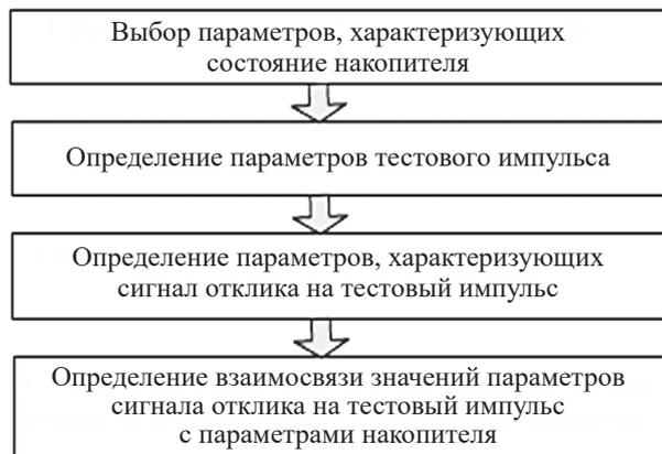
Рис. 3. Последовательность выполнения операций по определению значений параметров накопителя по параметрам сигнала отклика
