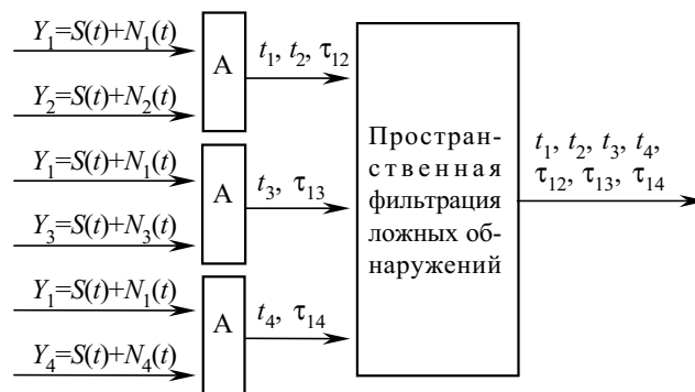
Рис. 4. Структура ПО сигналов в системе ПЗЛ, основанная на комбинации процедур предфильтрации, кросс-коррелятора и пространственной фильтрации ложных обнаружений (блок А раскрыт на рис. 3)
