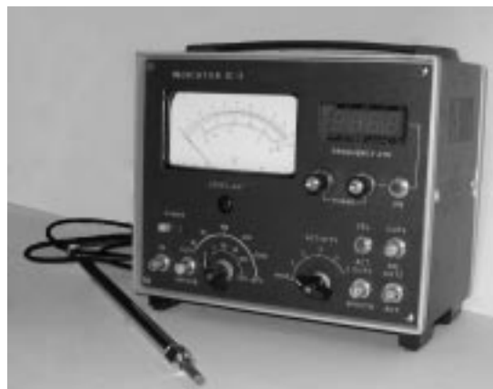
Рис. 8. Внешний вид индикатора активности кавитации
