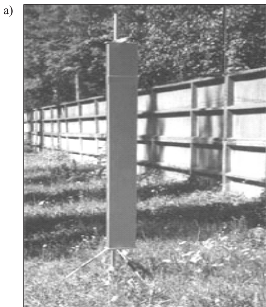
Рис. 3. Радиоволновой извещатель типа ЕМЦ200/2
