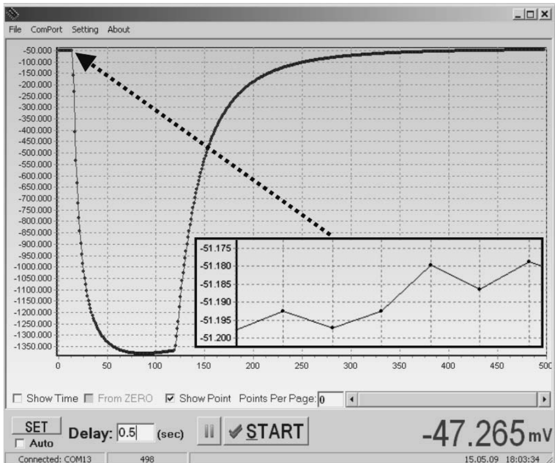
Рис. 5. Результат измерения выходного напряжения дифференциального термометра
